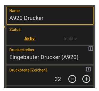
Klicken Sie auf den Button "Testdruck", der Drucker sollte nun drucken. Stellen Sie im Feld "Druckbreite" den Wert so ein, dass der Testdruck die gesamte Papierbreite ausfüllt. Für den A920 Drucker können Sie bis zu 32 Zeichen angeben. Der automatische Papierschnitt ist nicht verfügbar, Papier wird manuell abgerissen.
